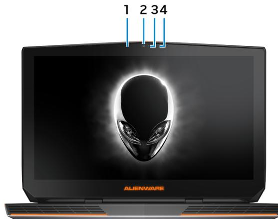
**1 Linkes Digital-Array-Mikrofon**
